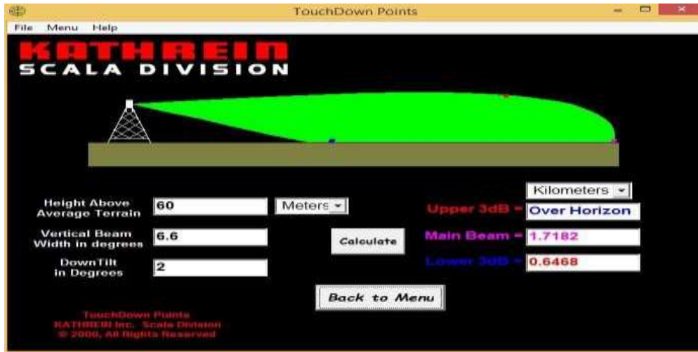
Gambar 7 Coverage Area Setelah Antena Ditinggikan
